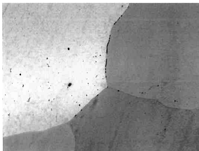
Figura 31 - Microestrutura de um aço ao manganês do tipo Hadfield com alto teor de cromo mantido na temperatura de 750°C pelo tempo de 1 minuto. Apresenta grãos de austenita com a presença de carbonetos re-precipitados na forma descontínua ao longo dos contornos de grãos. Ataque Nital 3%. Aumento 500x.
