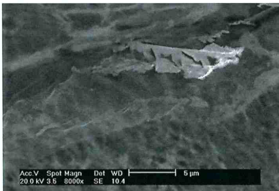
Figura 57 - Microestrutura de um corpo de prova com valor de energia de impacto de 190J e tempo de residência de 2 minutos a 750°C. Apresenta carbonetos precipitados em contornos de grãos na forma decontínua e a morfologia dendrítica dos carbonetos. Ataque profundo. (MEV) Aumento 8000x.
