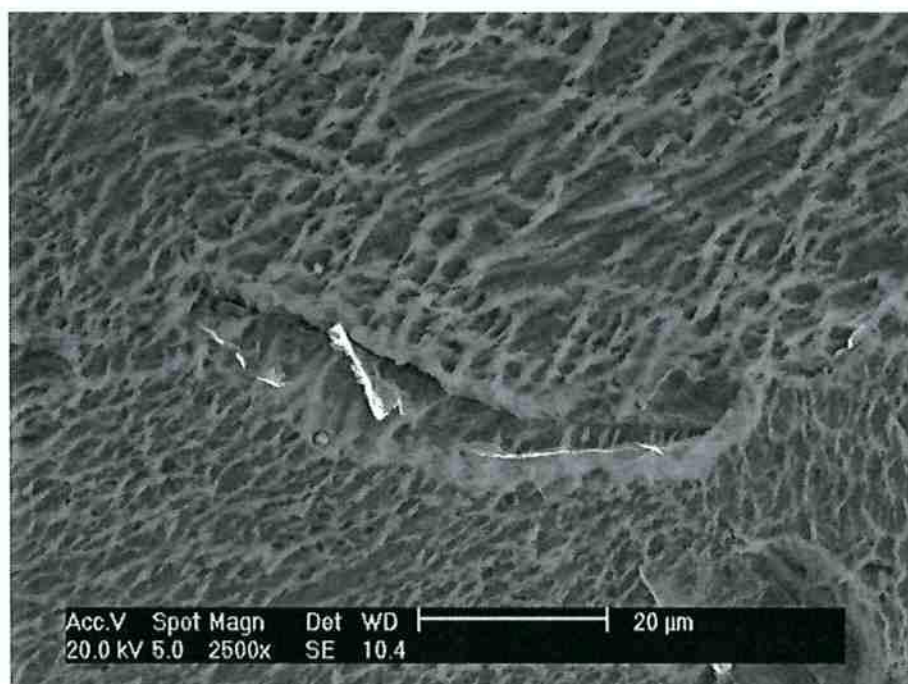
Figura 55 - Microestrutura de um corpo de prova com valor de energia de impacto de 190J e tempo de residência de 2 minutos a 750°C. Apresenta carbonetos precipitados em contornos de grãos na forma descontínua. Ataque profundo. (MEV) Aumento 2500x.
