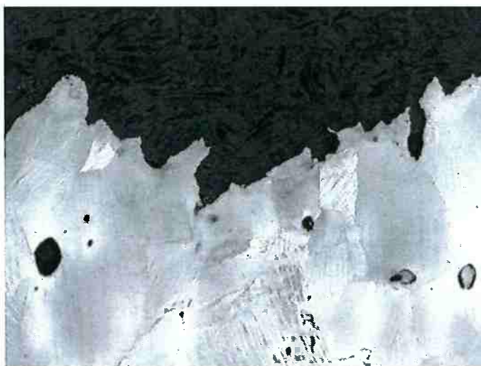
Figura 29 - Micrografia do corte longitudinal de uma corpo de prova, no estado solubilizado após a realização de ensaio Charpy. Nota-se o alongamento dos grãos de austenita e a presença de linhas de deformação gerados durante o ensaio de impacto. Ataque Nital 3%. Aumento 125x.
